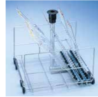
E 404/1 Injektorwagen • Zur Aufnahme von 38 Pipetten in 3 Reihen: 1. Reihe 10 Pipetten bis 100 ml (Länge bis 550 mm), Strebenabstand Halterung 20 mm 2. Reihe 14 Pipetten bis 25 ml, Strebenabstand Halterung 26 mm 3. Reihe 14 Pipetten bis 10 ml, Strebenabstand Halterung 26 mm • Ohne Haltevorrichtung für Magnetleiste ML/2 zur automatischen Wagenerkennung/Sprüharmensensierung
