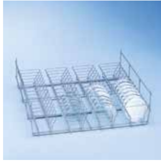
E 136 Einsatz 1/1 • Für 56 Petrihalbschalen mit 100 mm Durchmesser • 56 Halterungen, Höhe 70 mm • Abstand ca. 26 mm • H 145, B 485, T 445 mm
