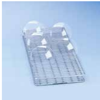
E 403 Einsatz 1/2 • Für 105 Uhrgläser mit 50-60 mm Durchmesser • 36 Streben, Abstand 9 mm • H 35, B 200, T 445 mm
