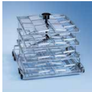
E 493 Wagen • Einsetzbar in PG 8536 • Für 8 Einsätze E 494 für Mikrotiterplatten in 4 Ebenen • Der untere Sprüharm der Maschine muss für ein optimales Spülresultat gegen den beigelegten Flansch ausgetauscht werden • Bestückungsmaße von unten: Ebene 1: 70 mm, Ebene 2: 85 mm, Ebene 3: 85 mm, Ebene 4: 90 mm
